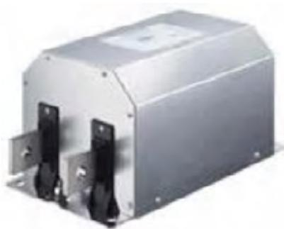
**FN2200Q1\*-250-99-R66\*** – FN2200 Standardfilter für 250 A mit 220 nF (**Q1**) Kondensatoren mit erhöhten Entladewiderständen (**R66** – 1,5 MOhm parallel zu X- und Y-Kondensatoren)
